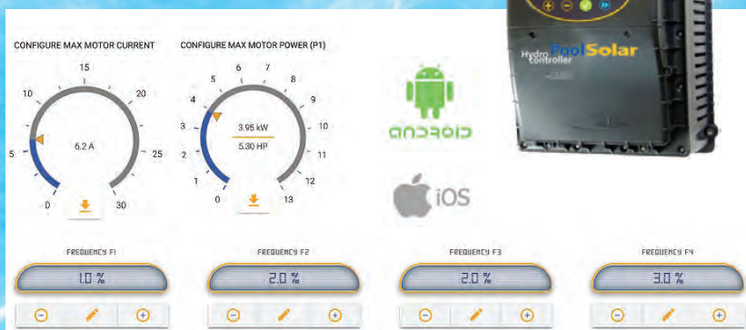
Szivattyú fordulatszám és áramfelvétel beállítás
